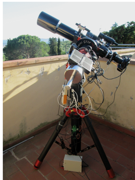
Il setup della postazione fissa. In questa versione al posto del RC 10" è stato montato il rifrattore Equinox 120/900
